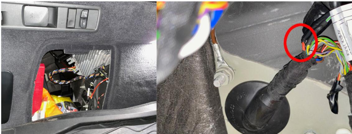
Diese laufen dann von der Eintrittsstellen in den Innenraum im Kofferraum bis zum BMW Active-Sound Steuergerät – beim 3er / 4er befindet sich dieses in der Regel in der Bodenmulde / dem mittleren Ablagefach unter dem Kofferraumboden:
