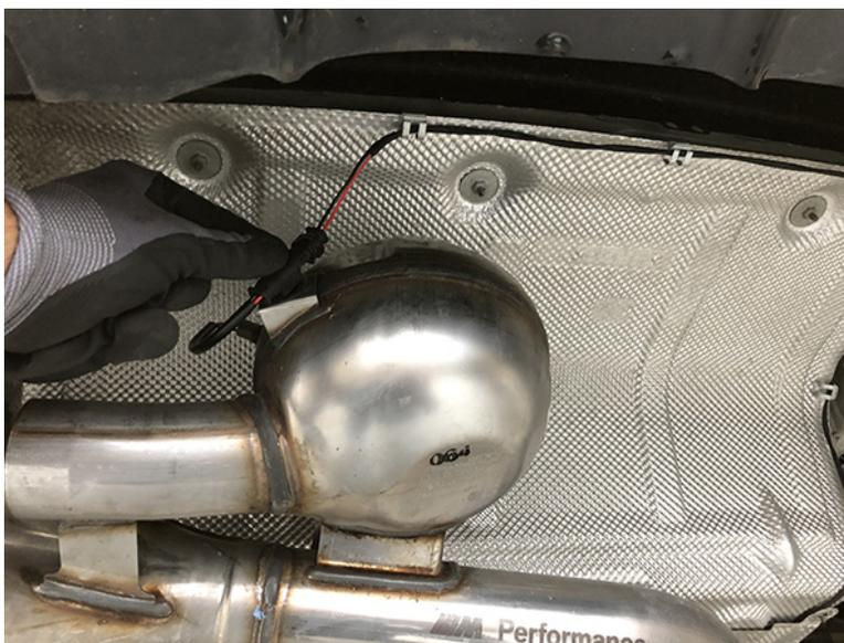
Das von der Kugel kommende kurze Kabelende wird dann unter dem Fahrzeug mit Hilfe einer Kabelklemme einfach mit dem von unserem System nach außen geführten Kabel wie folgt verbunden:
