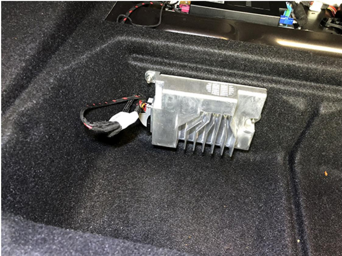
Identifizieren sie an beliebiger Stelle (an der Eintrittsstelle oder am Steuergerät) die beiden Kabel, die vom Soundbooster draußen kommen. Vergleichen sie dazu die Kabelfarben, die draußen am Soundbooster direkt angeschlossen sind (die Farben können je nach Baureihe abweichen).
