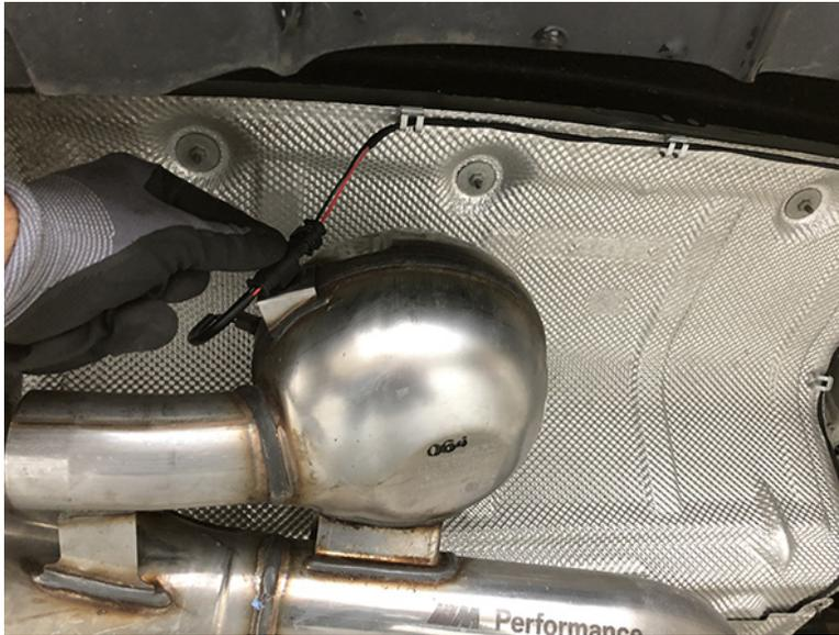
Diese laufen zum Beispiel beim 4er BMW dann irgendwo in den Fahrzeuginnenraum hinein – beim 3er und 4er meist im Bereich des rechten hinteren Radhauses – beim BMW X5 / X6 Go5 / G06 im Bereich der Kofferraum-Seitenwand links.
